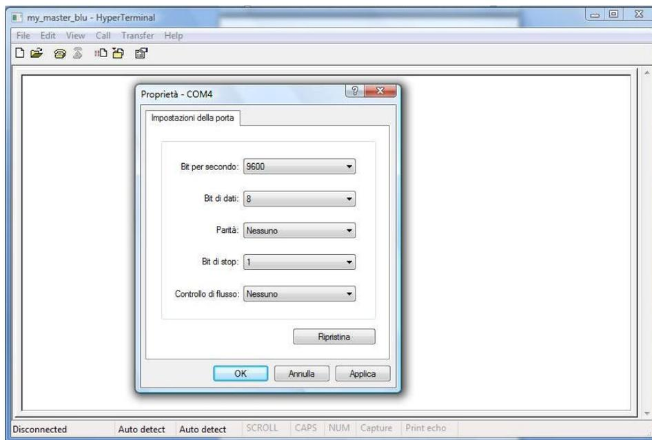
Al lancio del programma, l’utente deve assegnare un nome di fantasia alla connessione, selezionare la porta seriale utilizzata per il colloquio con il master-blu ed impostare i seguenti parametri di comunicazione: baud 9600, 8bit di dato, no parità, 1 stop bit, no controllo di flusso.
