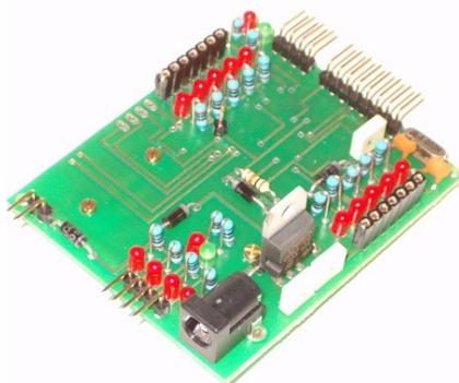
Con la realizzazione della nuova versione software, il pic-sms blu può essere utilizzato anche come scheda di interfaccia wireless; tramite il master-blu è possibile comandarne a distanza le uscite, accendere e spegnere eventuali relè connessi, leggerne lo stato degli ingressi digitali ed analogici, ricevere da esso gli allarmi relativi alle variazioni di stato degli ingressi ed al superamento delle soglie analogiche programmate.
