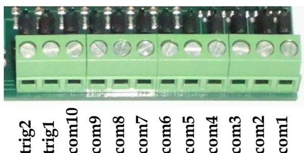
Ogni variazione di stato logico di tali ingressi, causa una variazione dell’uscita corrispondente sull’altra scheda connessa in rete (ad es. se com4 della scheda A passa allo stato alto, l’uscita 4 della scheda B si accende).
